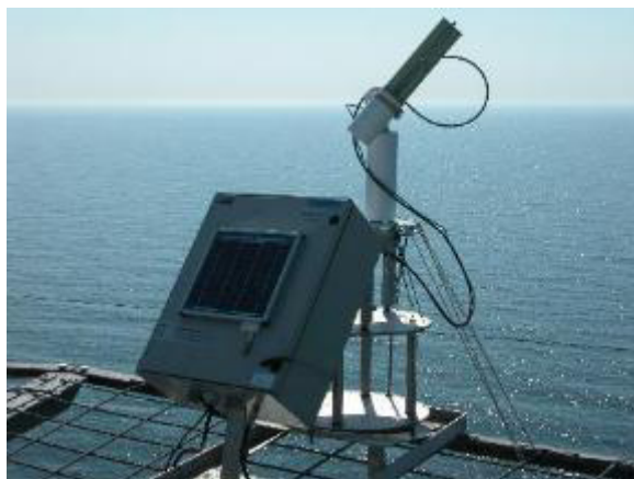
Radiometru oceanic instalat la Platforma "Secția 7"
